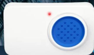
El EPP Digital de casco inteligente es un dispositivo diseñado para cascos. Su propósito principal es monitorear al personal, activar alarmas de caída, y alarmas SOS en diversos contextos industriales y de construcción, tanto en interiores como en exteriores. El EPP Digital es ideal para usar en minas, almacenes, túneles, y sitios de construcción, y su consumo de energía ultra bajo garantiza una duración de la batería de aproximadamente tres años, haciéndolo altamente eficiente.
